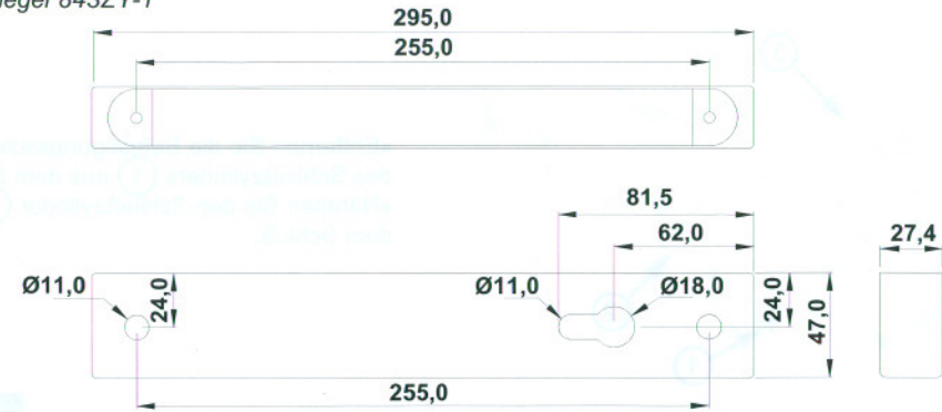
Montagegehäuse 843ZY-4-1 in Edelstahl mit Profilylinderlochung, passend für Elektroriegel 843ZY-1
