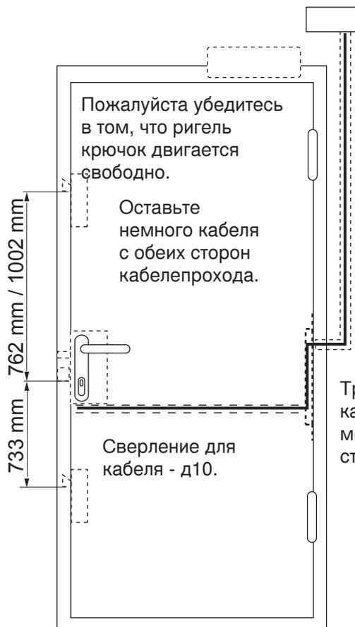
Пожалуйста проверьте дверной зазор, если корпус замка устанавливается на поверхности. Дверной зазор должен быть мин. 8,5мм и макс. 15мм. ( Дверной зазор между запорной планкой и корпусом замка должен быть 2-5,5мм.)
