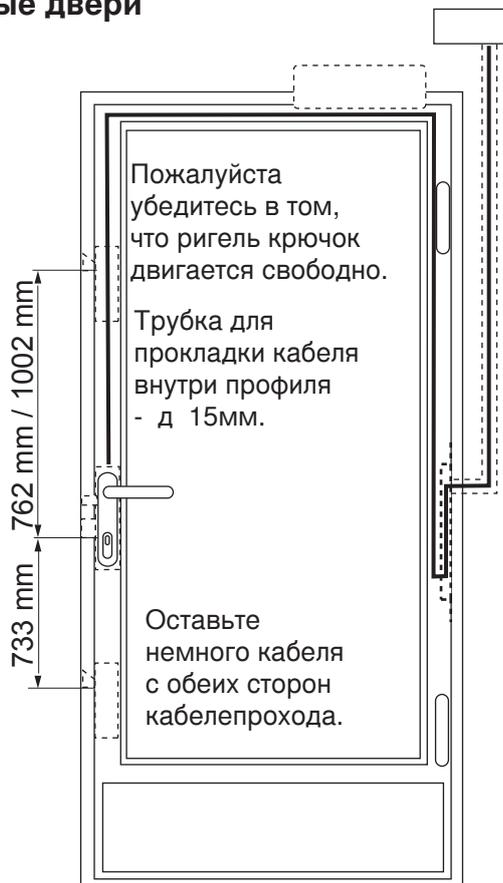
Трубка для прокладки кабеля внутри - д20мм.
