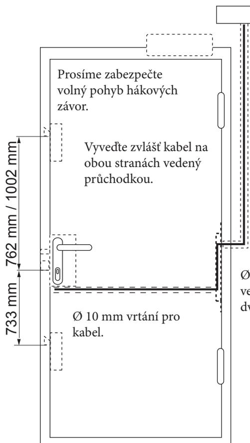
Pokud nebude zámek zapuštěný, ale montován na povrch drážky, je nutné dodržet technickou mezeru v rozmezí min. 8,5 až 15mm ( tzn. mezera mezi protiplechem a tělem zámku by měla být 2 až 5,5mm.)
