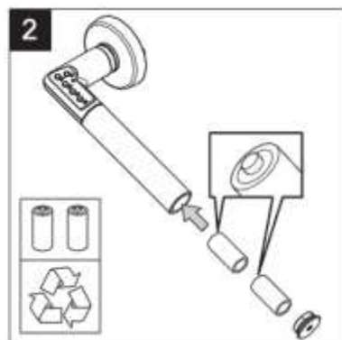
2. Stiskněte kliku a nechte baterie vypadnout. Vložte dvě nové baterie. Dejte pozor na polaritu
