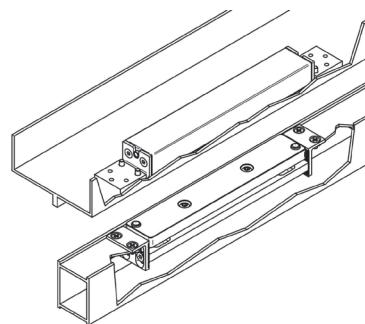
Montáž magnetu musí být stříh. **Pozor: Není určen pro montáž na odtrh.**
